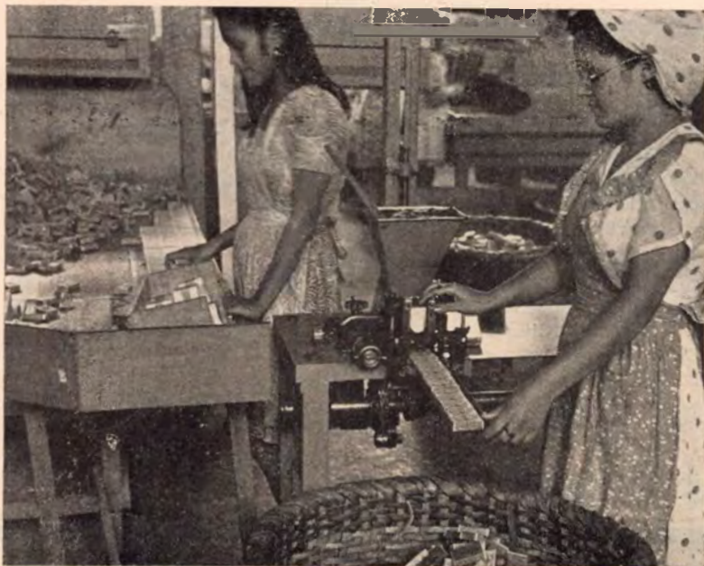
Este rincón nos da una idea de cómo se llenan las cajetillas de fósforos y la otra máquina le pone el ropaje que acredita su prestigio
